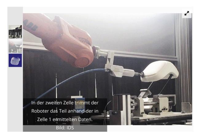
Zum schnellen und exakten Trimmen von Schaumstoffteilen für Armlehnen und Kopfstützen kommt bei Adient eine Roboterautomation mit Ensenso 3D-Kameras von IDS zum Einsatz.
