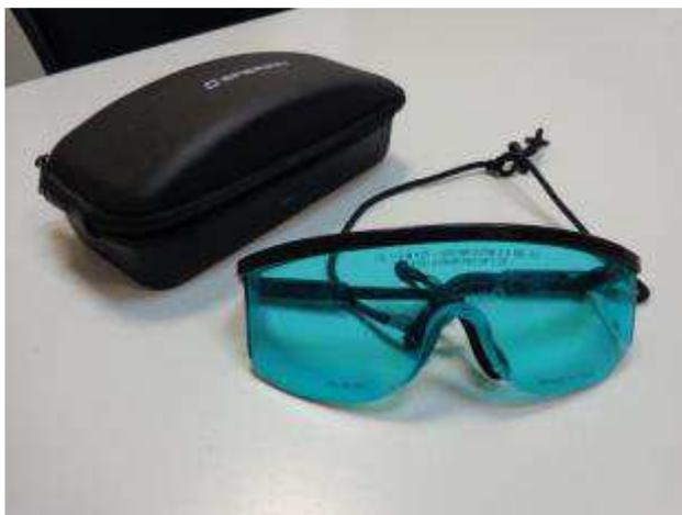
Figure 20: Lunettes de protection spécifiques au laser de classe IIIB
