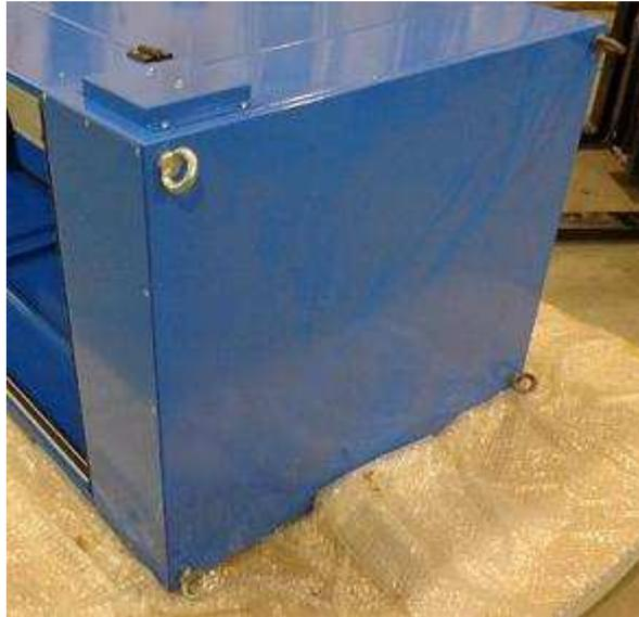
Figure 13 : Anneaux de levage aux 4 coins de la cabine
