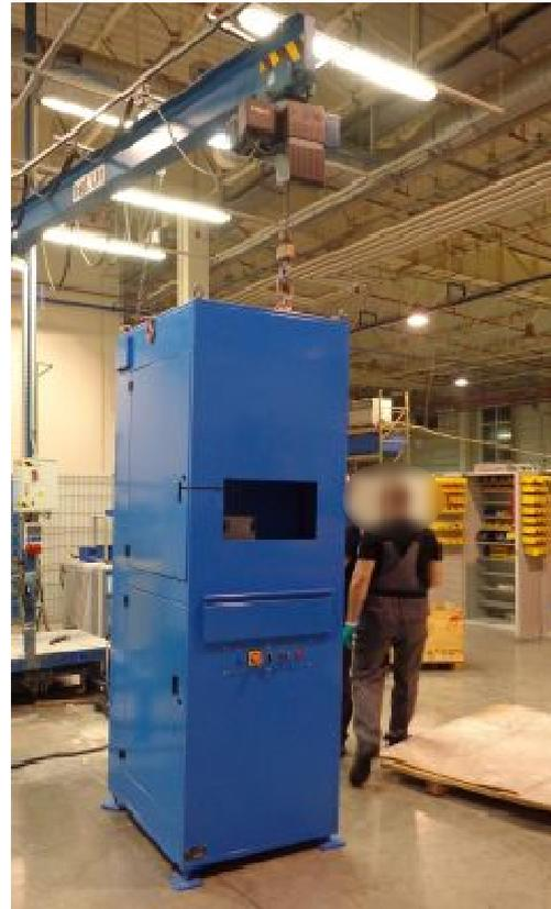
**Figure 14 : Levage de la cabine via les anneaux**
