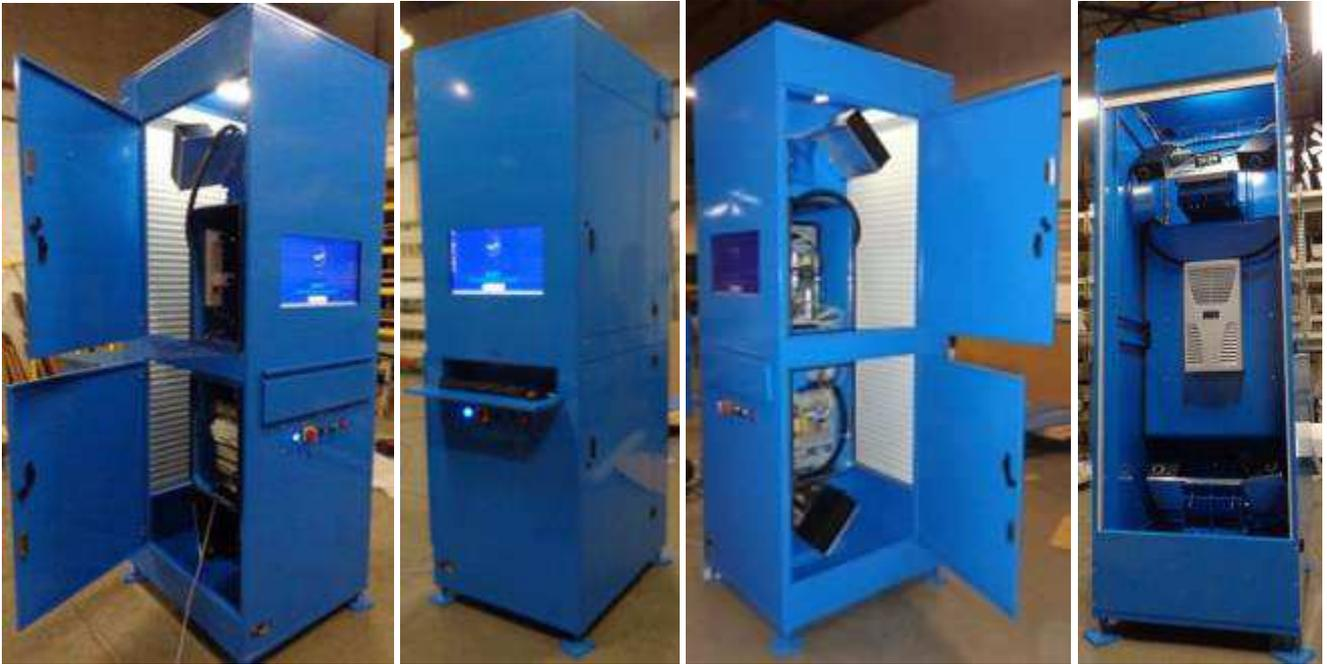
Figure 5: Vues des 4 côtés de la cabine. De gauche à droite : côté gauche (2 portes), côté opérateur (écran, boutons de commande), côté droit (2 portes), côté rideau
