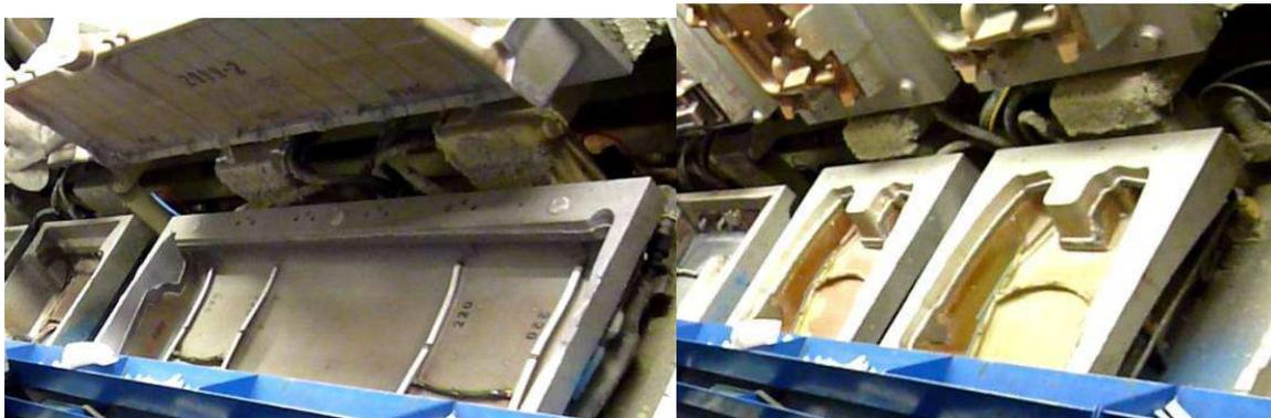
**Figure 8: Différents moules sur la ligne de production et chariot de même taille**
