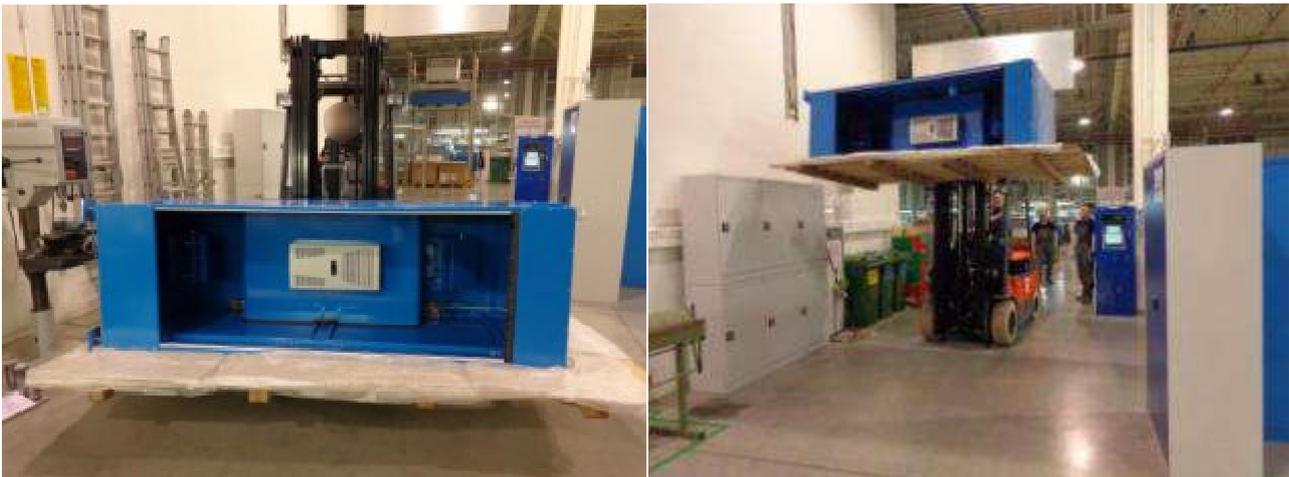
Figure 12: Déplacement de la cabine encore sur palette, position basse à gauche, position haute à droite
